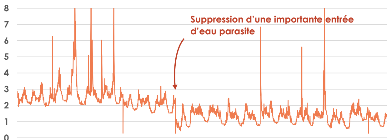
Débit eau brute - Entrée station de traitement (m3/h)
